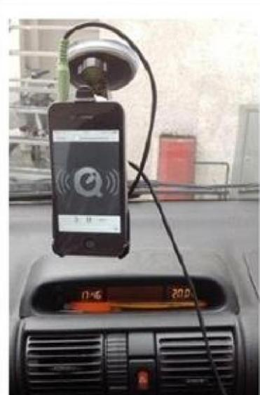
Si el dispositivo móvil se usa para operar el sistema (por ejemplo, cambiar la pista sería suficiente), no debería haber ningún cable visible (sin embargo, ¡el conector está bien visible)!
